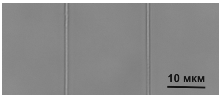
Рисунок 1. Лазерная модификация в объеме стекла состава 0.2\text{K}_2\text{O-0.7SiO}_2\text{-0.1Nb}_2\text{O}_5
