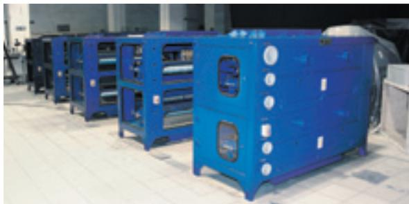
Высокоиндуктивный магнитный сепаратор СМВИ для обогащения кварцевых песков
