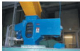
Магнитный сепаратор СМВА, для очистки доломита, соды, огнеупорных материалов
